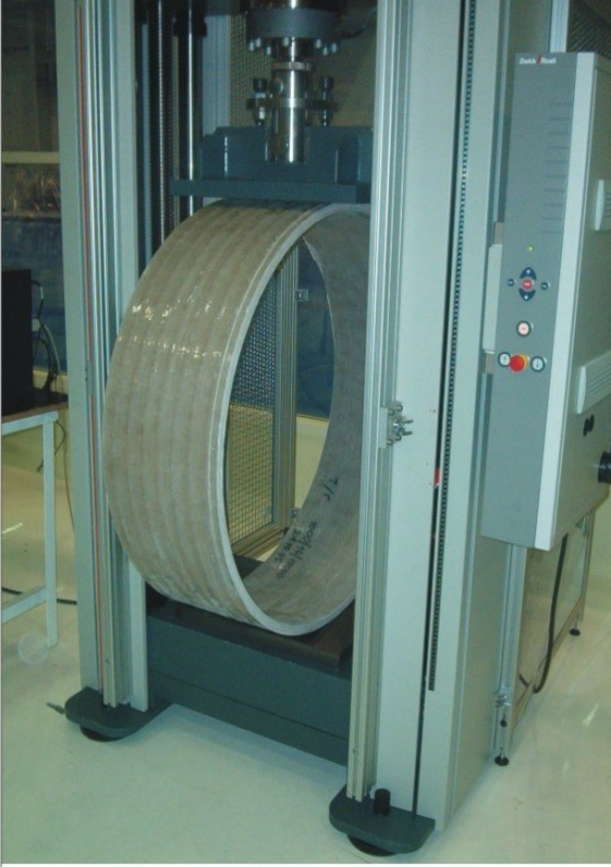
Büyük çaplı cam elyaf boru basma testi
